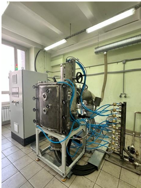
ПЕЧИ ДИСТИЛЛЯЦИИ РЗМ (очистка до 99,99% в вакууме)
