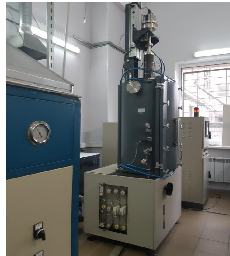
УСТАНОВКИ ДЛЯ ВЫРАЩИВАНИЯ МОНОКРИСТАЛЛОВ (метод Чохральского)
