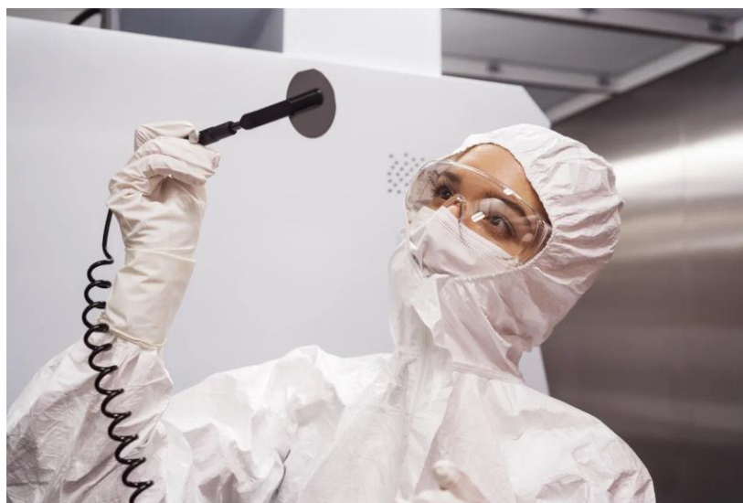
Рис. 6. Контроль качества полированных пластин сотрудником лаборатории низкотемпературных полупроводниковых соединений АЗВ5 в чистой комнате.
