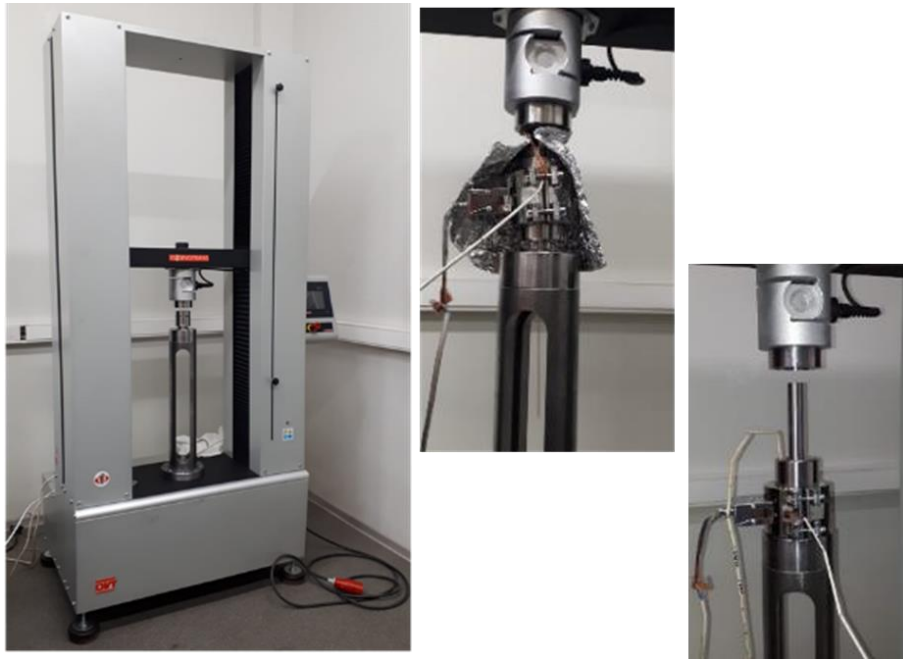
Рис. 17. Универсальная электрическая испытательная машина FUDLC 200 кН, модифицированная специальной оснасткой для экструзии
