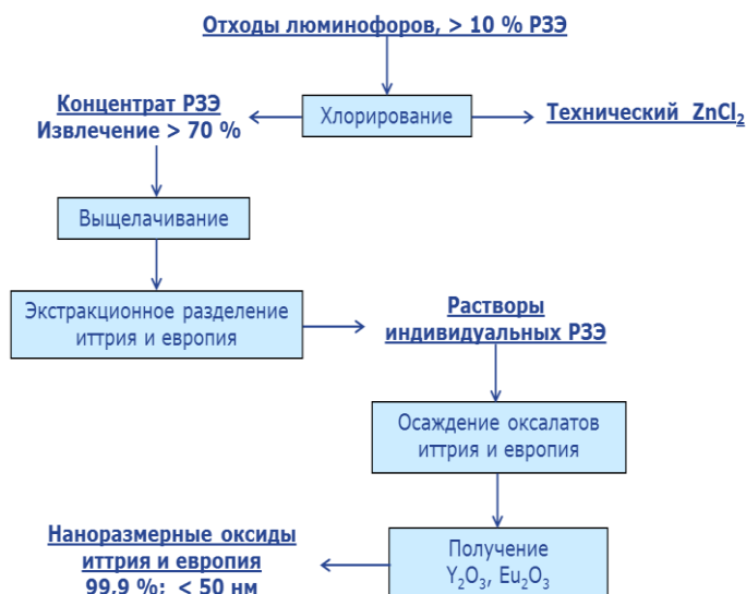
Рис. 21. Схема разработанной технологии переработки техногенного сырья
