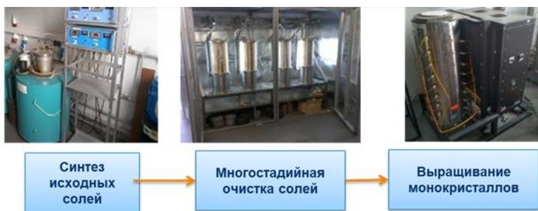
Рис. 16. Принципиальная схема выращивания монокристаллов состава TlCl-TlBr (КРС-6), TlBr-TlI (КРС-5), TlBr , AgCl-AgBr , др. и оптических заготовок
