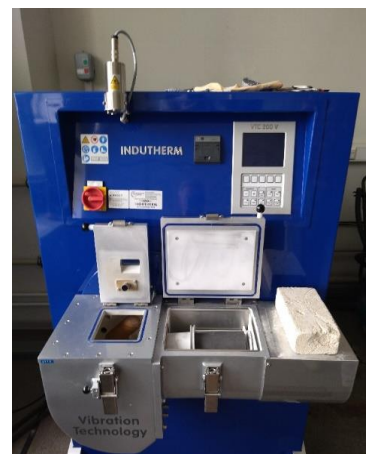
Рис. 14. Индукционная печь для производства эвтектики Li – Pb
