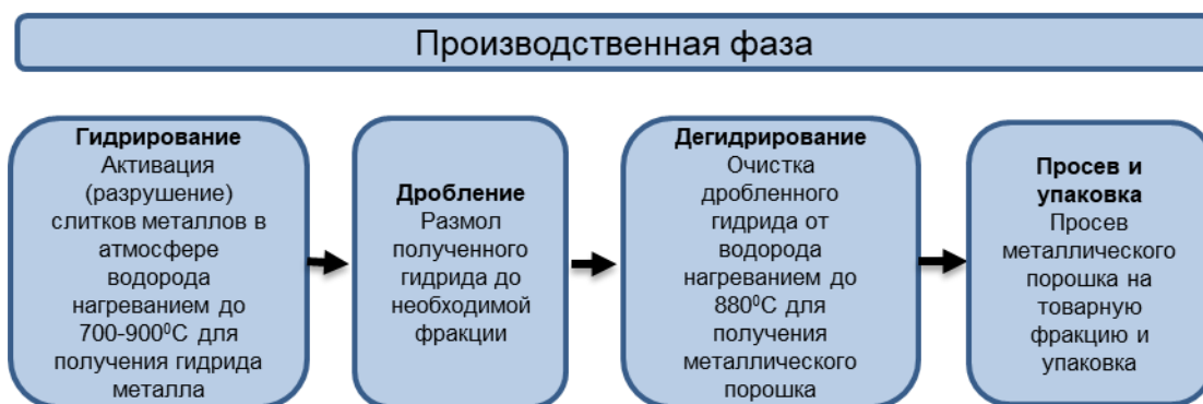
Рис. 42. Принципиальная технологическая схема производства металлических порошков Ta, Nb, V
