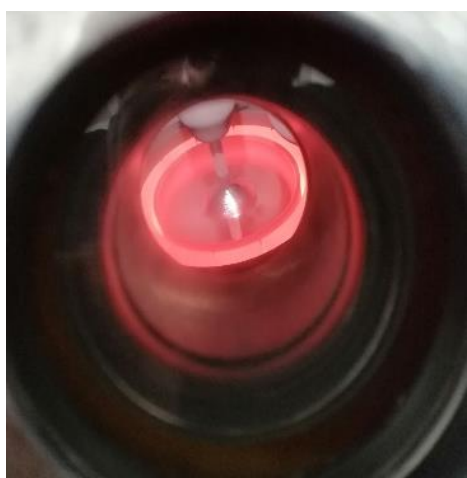
Внешний вид растущего кристалла методом Чохральского на ориентированную затравку в ориентации 100
