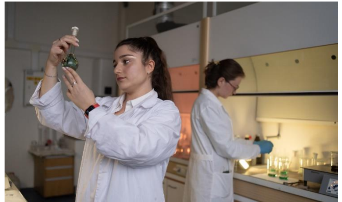
Химическая подготовка проб для атомно-эмиссионного с индуктивно-связанной плазмой анализа (ISP-OES)
