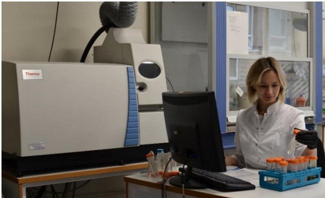
Анализ образцов на масс-спектрометре с индуктивно-связанной плазмой (ICP-MS)
