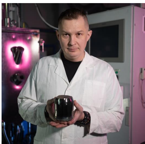
Монокристалл InSb, полученный в лабораториях АО «Гиредмет» с применением метода Чохральского
