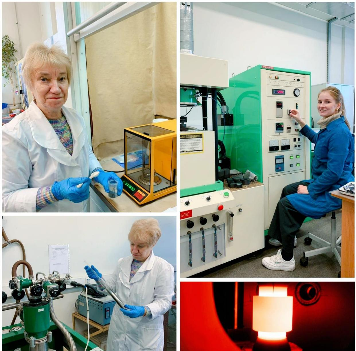
**Рисунок 30.** Получение термоэлектрического материала методом искрового плазменного спекания
