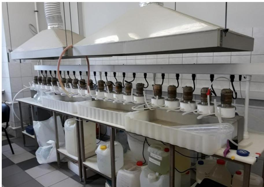
**Рисунок 8.** Экстракционный каскад, состоящий из экстракторов центробежного типа модели ЭЦ-10ФА
