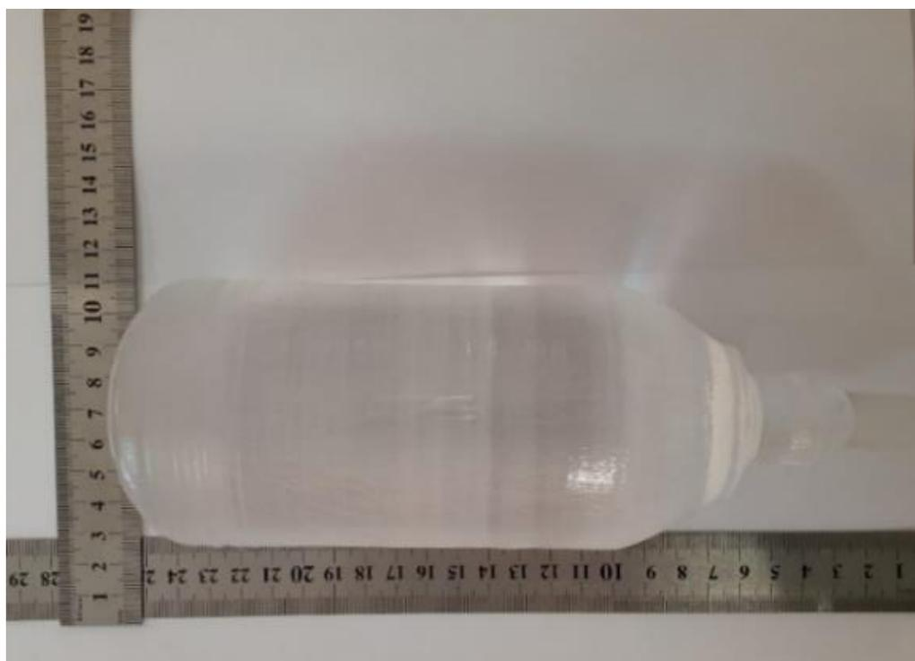
**Рисунок 33.** Монокристалл ортосиликата лютеция, активированного церием ( $\text{Lu}_2\text{SiO}_5:\text{Ce}^{3+}$ ), выращенный в АО «Гиредмет»
