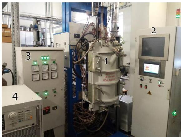
**Рисунок 18.** Общий вид модернизированной установки для выращивания кристаллов арсенида галлия в магнитном поле:
