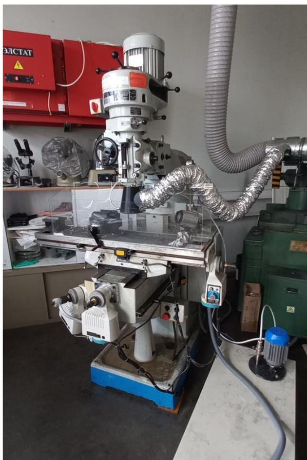
**Рисунок 29.** Станок вертикально-фрезерный X6323A1
