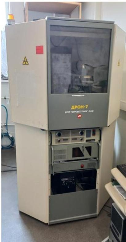
**Рисунок 28.** Рентгеновский дифрактометр общего назначения «ДРОН-7М»
