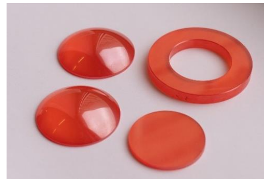
ОПТИЧЕСКИЕ ЭЛЕМЕНТЫ ИК-ДИАПАЗОНА Призма (заготовка) из KPC-6 (TlCl-TlBr) Окно из KPC-5 (TlBr-TlI) Светоделительное кольцо из KPC-5 (TlBr-TlI) Призма МНПВО из KPC-5 (TlBr-TlI) Призма из KPC-5 (TlBr-TlI)
