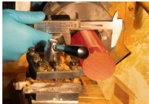
МОНОКРИСТАЛЛЫ галогенидов таллия KPC-5 (TlBr-TlI) и KPC-6 (TlCl-TlBr)
