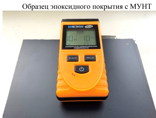
Рис.1. Сравнение электропроводящих свойств покрытий на основе эпоксидного связующего с МУНТ производства LG Chem, Cnano, Nanocyl и ИК СО РАН
