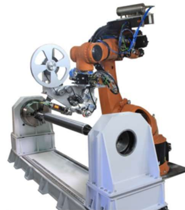
Робототехнический комплекс намотки и выкладки армированной термопластичной ленты
