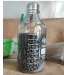
Сырье – гранулы диоксида гафния
