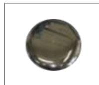
Ga марки 7N, получен из отходов полупроводникового производства
