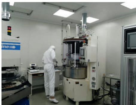
Полировка полупроводниковых пластин в чистой зоне (лаборатория обработки полупроводниковых материалов в чистой зоне)
