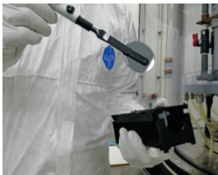
Полировка полупроводниковых пластин в чистой зоне (лаборатория обработки полупроводниковых материалов в чистой зоне)
