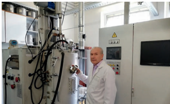
Выращивание монокристалла GaAs методом Чохральского. Работа проводится под руководством С.Н. Князева — начальника лаборатории высокотемпературных полупроводниковых соединений A^3B^5
