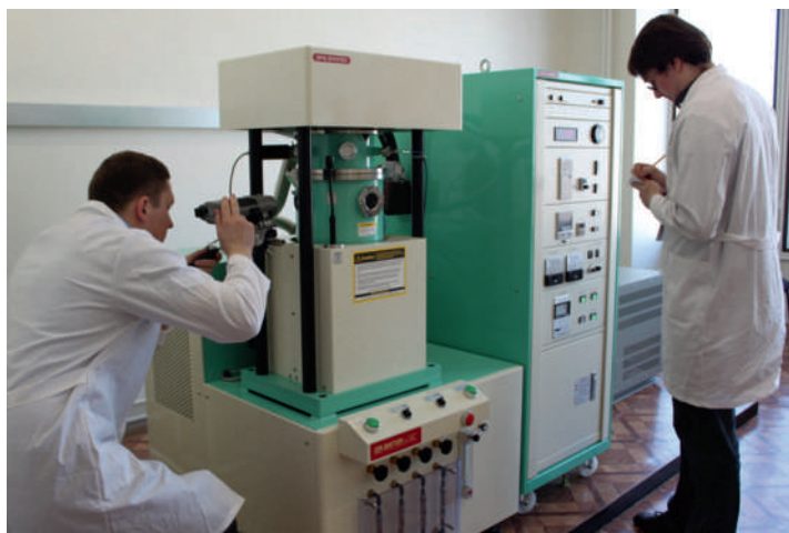
Проведение процесса компактирования объемных наноструктурированных термоэлектрических материалов методом искрового плазменного спекания на установке SPS-511S
