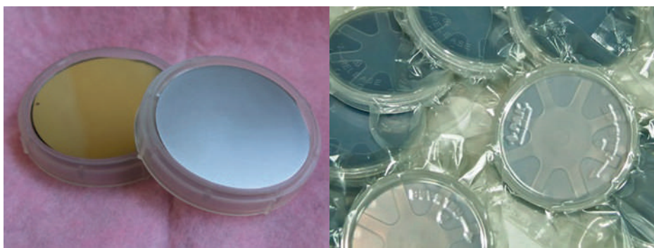
Пластины антимонида индия и арсенида галлия подготовленные в лабораториях АО «Гиредмет» для процесса эпитаксии (epi-ready)
