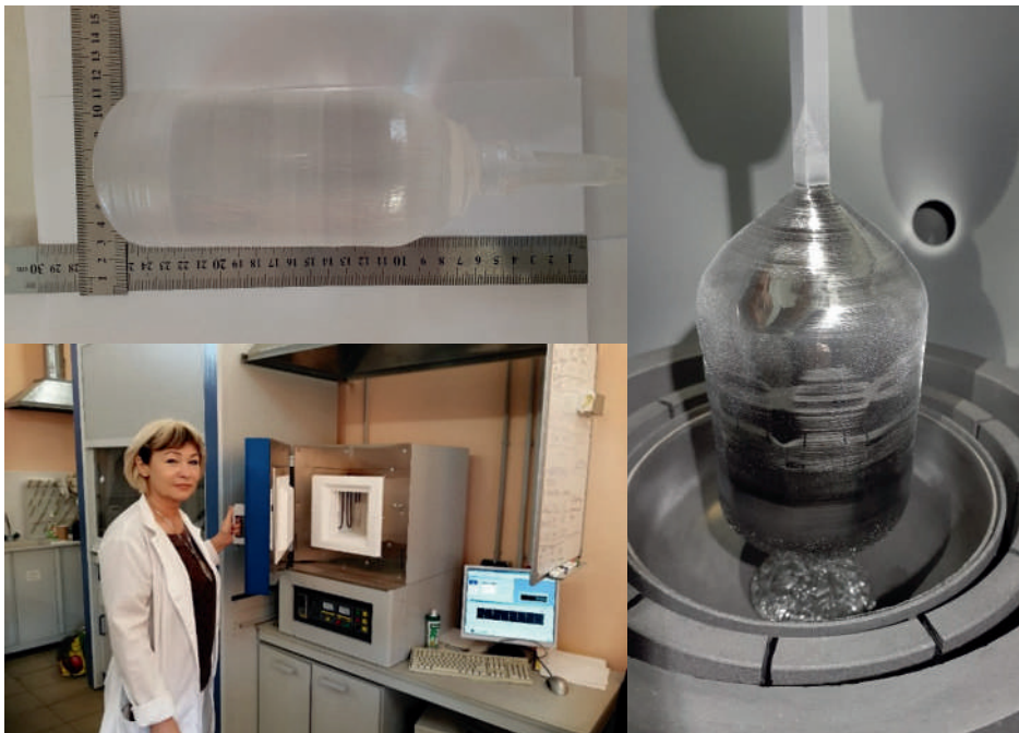
Самый крупный в мире монокристалл ортосиликата лютеция, активированного церием ( \text{Lu}_2\text{SiO}_5:\text{Ce}^{3+} ), полученный в лаборатории технологий получения веществ особой чистоты под руководством к.т.н. О.В. Юрасовой
