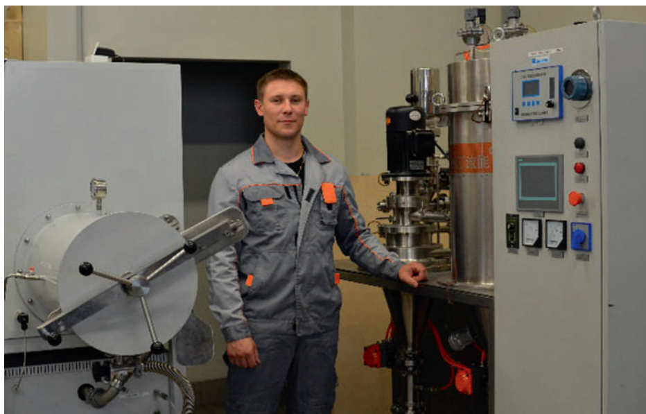
Работа сотрудника лаборатории Д.В. Коротаева на классификаторе для сфероидизации порошков металла (Ta, Ti, Nb, Mo и т.д.)
