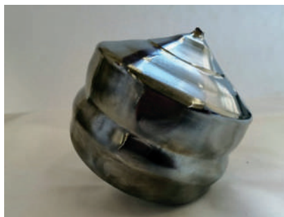
Выращенный в лаборатории низкотемпературных полупроводниковых соединений A 3 B 5 монокристалл InSb массой ~ 5 кг
