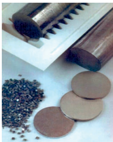
Готовые слитки и пластины халькогенидов Bi и Sb , полученные научными сотрудниками лаборатории термоэлектрических материалов
