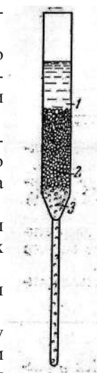
Рис. 1 Эскиз колонки для фильтрования азотнокислых висмутовых растворов от серебра: 1. раствор 2. металл, смешанный со стеклом 3. стеклянная вата
