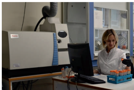
Проведение анализа образцов на масс-спектрометре с индуктивно-связанной плазмой (ICP-MS) начальником ИАСЦ Е.С. Кошель
