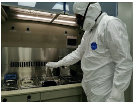
Обработка пластин на ультразвуковой линии отмывки в лаборатории обработки полупроводниковых материалов в чистой зоне
