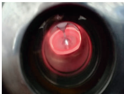
Внешний вид растущего кристалла InSb методом Чохральского
